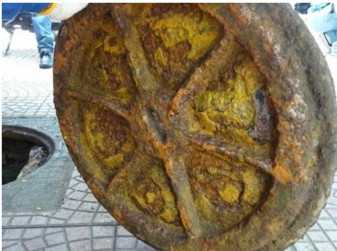
鉄蓋裏面の腐食状況
